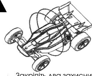
Закріпіть два захисних кільца до машинки
