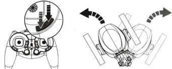
Якщо робота тягне вперед або назад, то натискайте протилежну цьому напрямку кнопку триммера балансу до тих пір, поки робот не вирівнюється.
