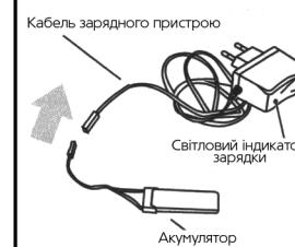
Для зарядки акумулятора з'єднайте кабель зарядного пристрою з проводом акумулятора. Для безпеки, не можна залишати акумулятор що заряджається без нагляду.
