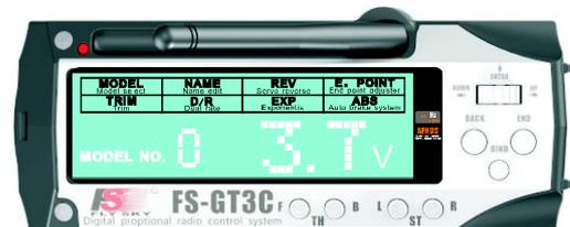
На следующем экране показывается случай, когда напряжение аккумулятора падает ниже 3.7 В
